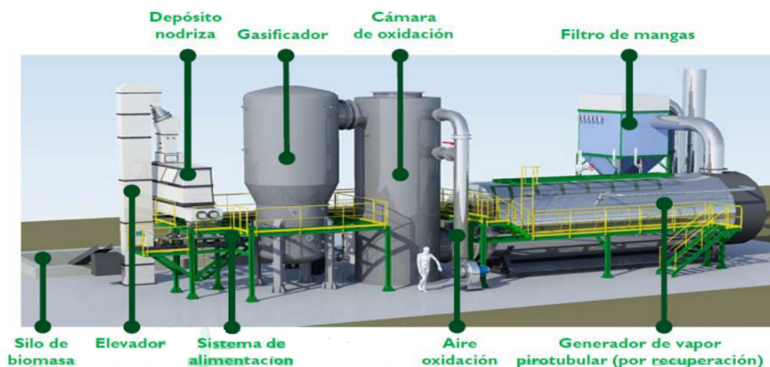
Esquema del proceso de gasificación de biomasa
