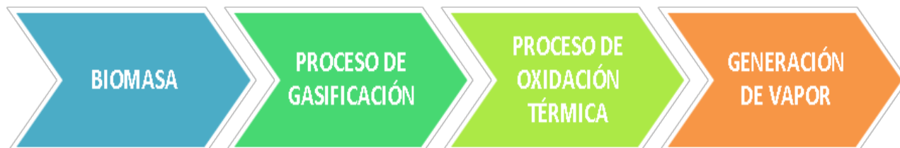
Esquema del proceso de gasificación de biomasa
